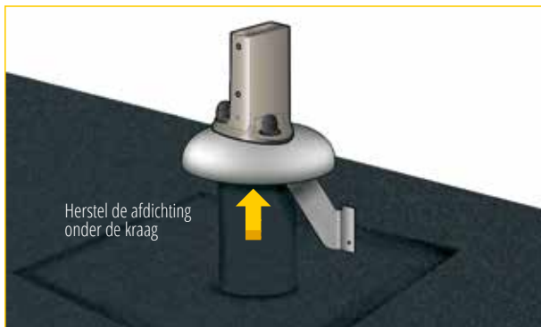
7 - Voer uw isolatie + omgezette rand uit. > Model zonder mof: voer uw omgezette rand uit tot onder de kraag.
